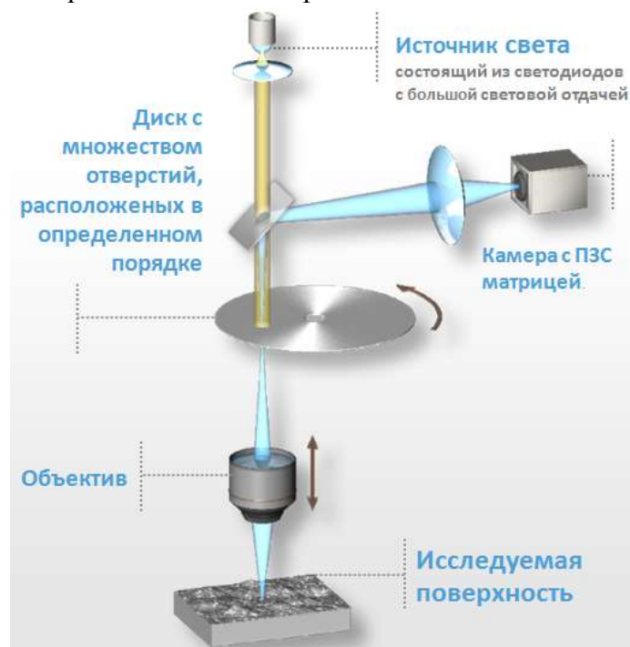
Рис.2 Схема работы технологии µsurf
