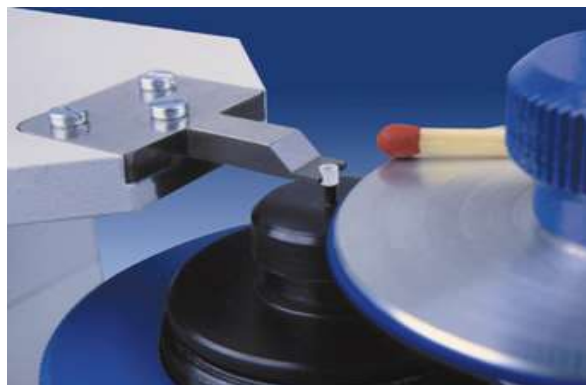
Рис. 3. Измерение децентровки микролинзы.
