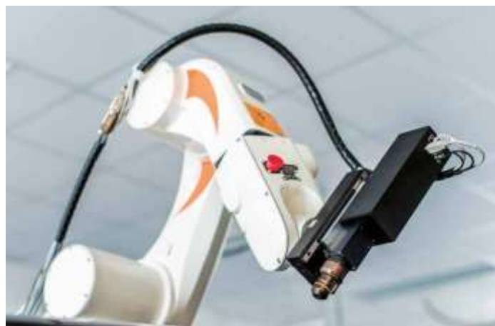
Рис. 1 Общий вид измерительной установки µsurf , установленной на работе.
