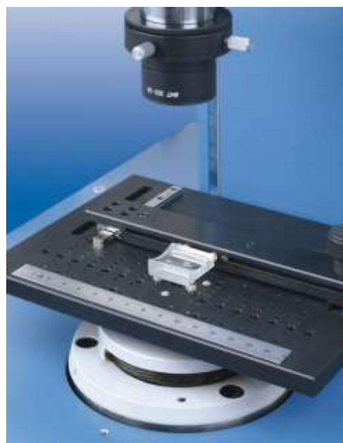
Рис. 10. Цилиндрическая линза с плоским основанием, установленная на приборе серии OptiCentric при помощи модуля CylinderCheck.
