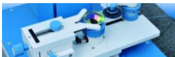
Рис. 4. Измерение децентровки ИК линзы
