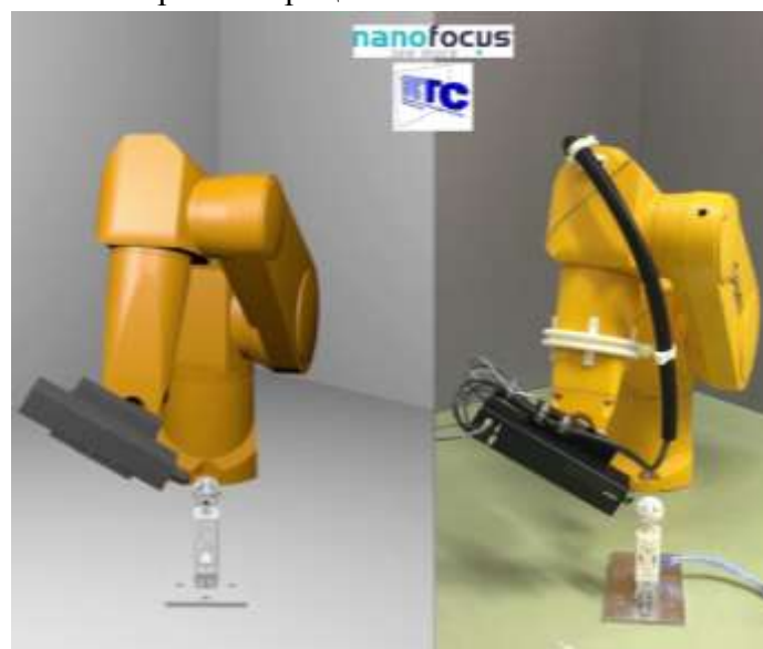
Рис. 4 Измерение детали полученной в результате 3D печати.
