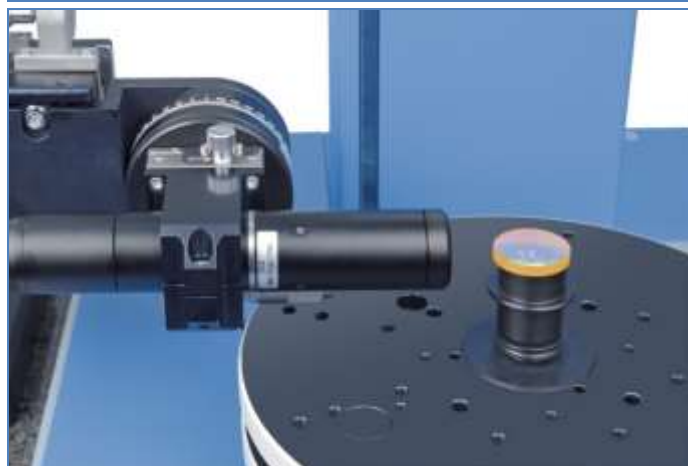
Рис. 9. Измерение линзы с центральным отверстием (сверху) и измерение децентрировки одиночной линзы относительно наружной кромки.
