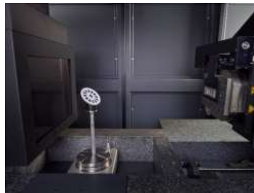
TomoScope S: детектор высокого разрешения 3888x3072 пикселей
