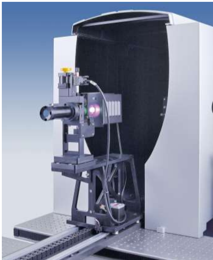
Рис.7. Стойка с источником света для контроля оптических систем, работающих с конечного расстояния.
