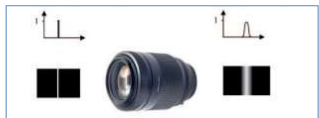
Рис.3. Функция рассеяния линии, на основе которой строится график ЧКХ.
