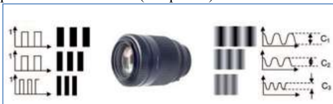
Рис. 1. Уменьшение контраста изображения после прохождения через оптическую систему.
