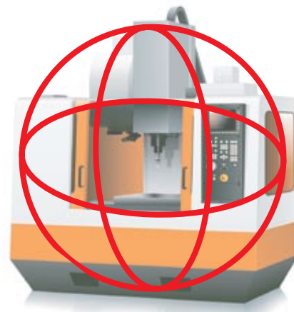
Идеальные окружности по осям X, Y и Z отражают идеальное состояние станка
